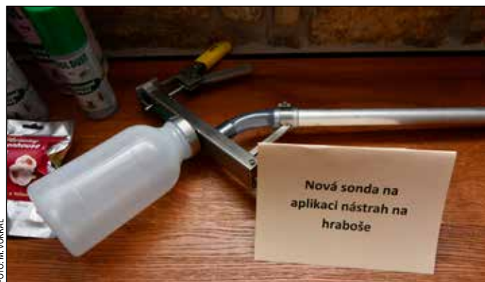
Obr. 6 – Prototyp sondy na aplikaci nástrah Stutoxu do nor hraboše polního
