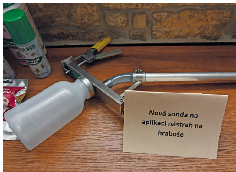
prototyp sondy na aplikaci nástrah Stutoxu do nor hraboše polního
